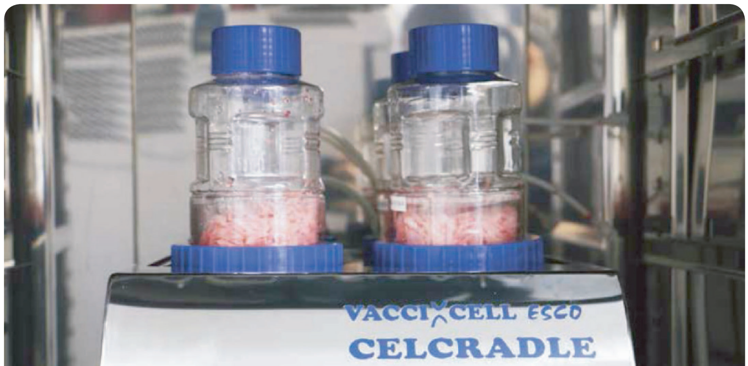
Hình 5: CelCradle-500AP: mật độ tế bào cao đạt được trong nuôi cấy 3D so với nuôi cấy 2D
